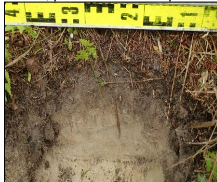
Vasen: Koekuoppa nro. 5, pintahumuksen alla maaperä savea. Oikea: Koekuoppa nro 6, maaperä hiesua. .Alla: Koekuoppa nro 7, pintahumuksen alapuolella maaperä hiesua
