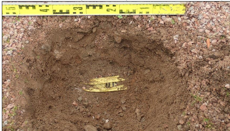
Koekuoppa 9. Ylinnä kerros pihalle ajettua soraa ja hiekkaa. Pohjalla kaapelinauha aiemmin asennetun kaapelin kohdalla. Alla Koekuoppa 10. Pihalle ajettua soraa ja hiekkaa. Alinna isohkot kivet.
